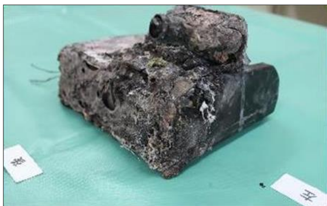
▲充電中に出火した急速充電器と非純正バッテリー
