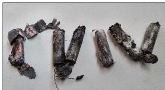
▲焼損した非純正バッテリーを分解し、バッテリーセルを撮影したもの
