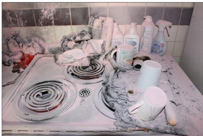
▲電気こんろ周辺の焼損状況 (消火器使用後)
