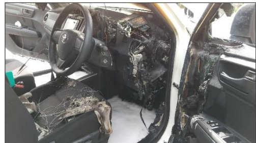
▲運転席付近の焼損状況
