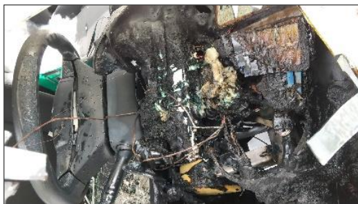
▲ダッシュボード付近の焼損状況
