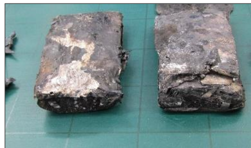
▲モバイルバッテリーの焼損状況
