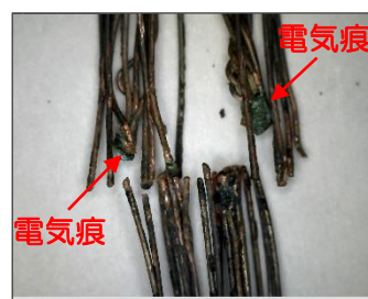
▲断線部分をマイクロSCOPEで拡大
