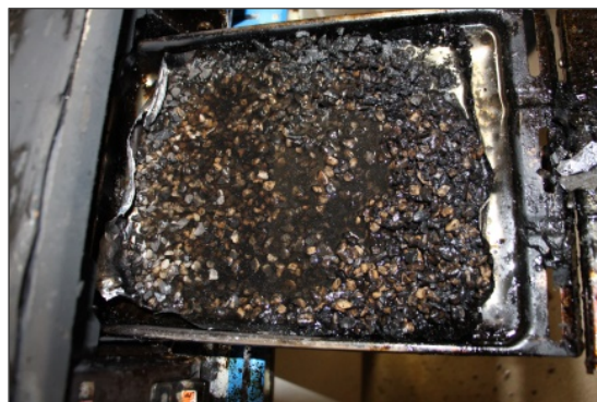
▲グリル内の状況。グリル敷石が黒く変色している。
