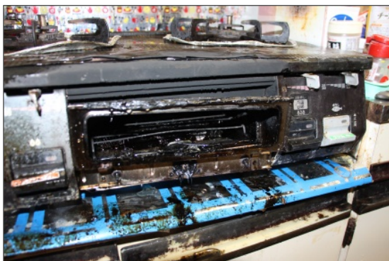
▲グリル焼損状況
