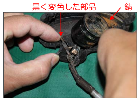
▲Aの防水型コネクタ内部。金属部品が黒く変色しており、カバー内に錆が認められる。
