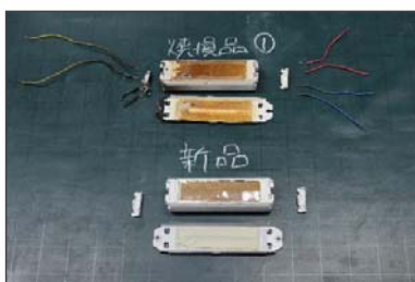
▲蛍光灯安定器を取り出し、新品と比較しつつ鑑識を行う。
