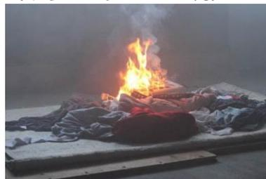
6分50秒で底部側から炎発生。7分10秒～20秒頃には電気ストーブ表面の温度が最高 230° から下がり始め、この時点で温度ヒューズが切断し、電源が切れたものと推測される。しかし、その後も燃焼は継続し、9分25秒には電気ストーブ全体が炎に包まれた。
