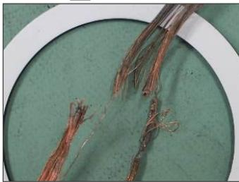
▲1～5には短絡痕が発生している。短絡は器具側から順番に発生したと推測できることから、1が最初に短絡が発生した部分と推測でき、1周辺の状況から今回の火災原因を突き止めることができた。
